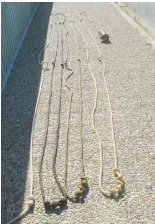
Figura 3. Visión global de uno de los testigos colocados en la presa de Iznájar.
