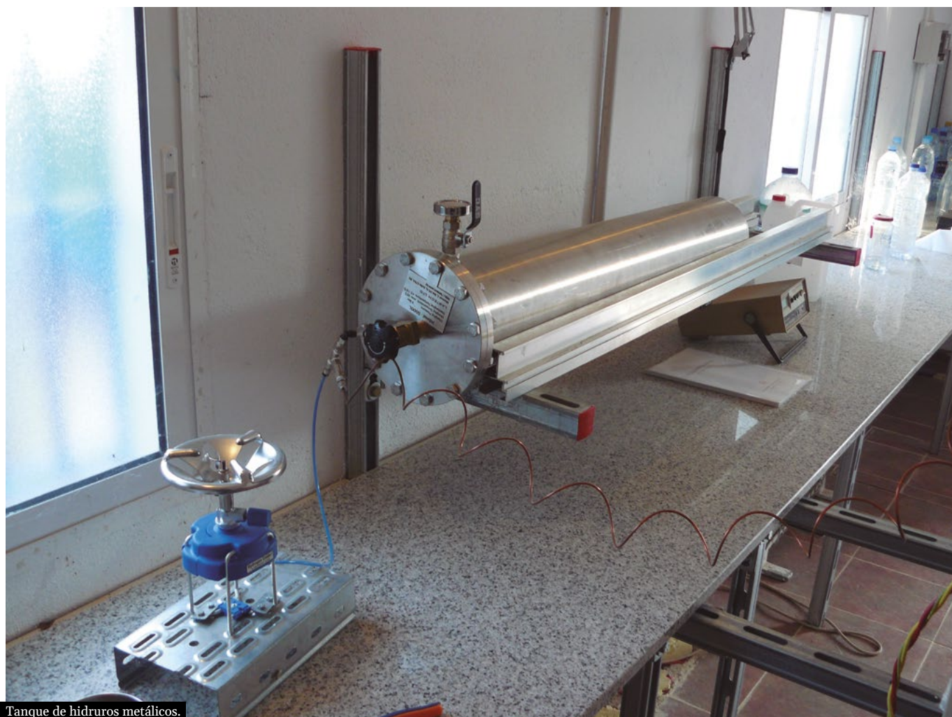
Tanque de hidruros metálicos.
