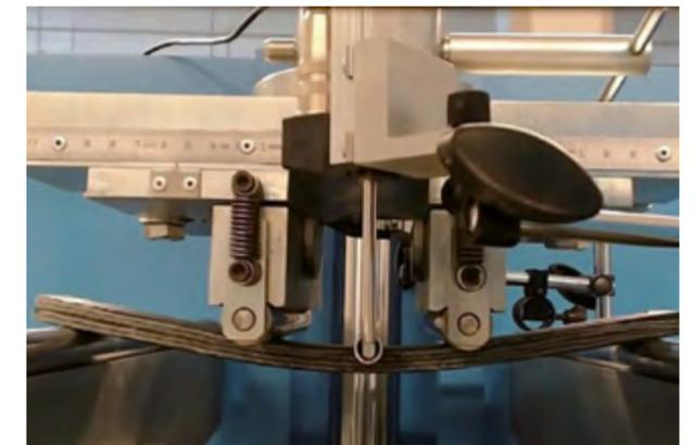
Medición de resistencia y flexibilidad del material
