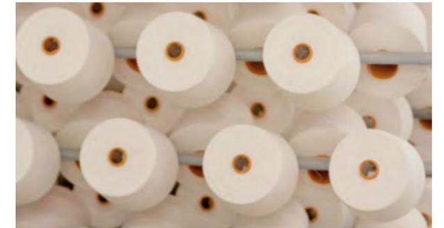
Hilos de alta resistencia compuestos principalmente de material reciclado postconsumo
