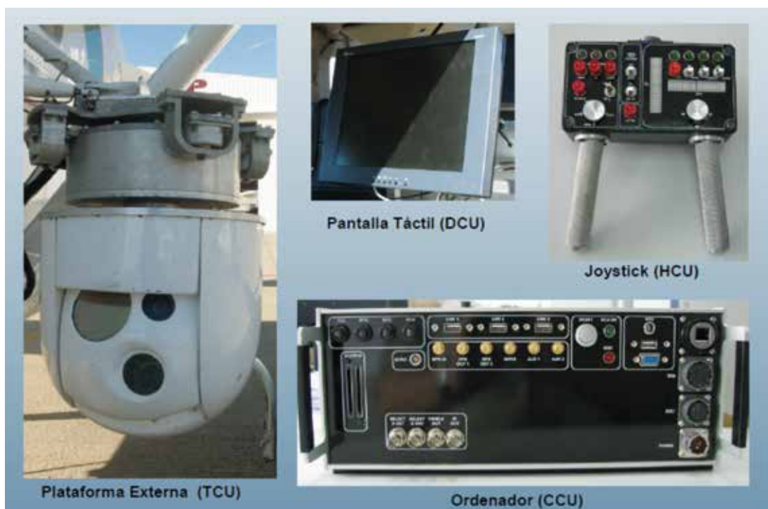
Figura 2. Equipos que integran el Sistema Aire, EINFOREX-B.
