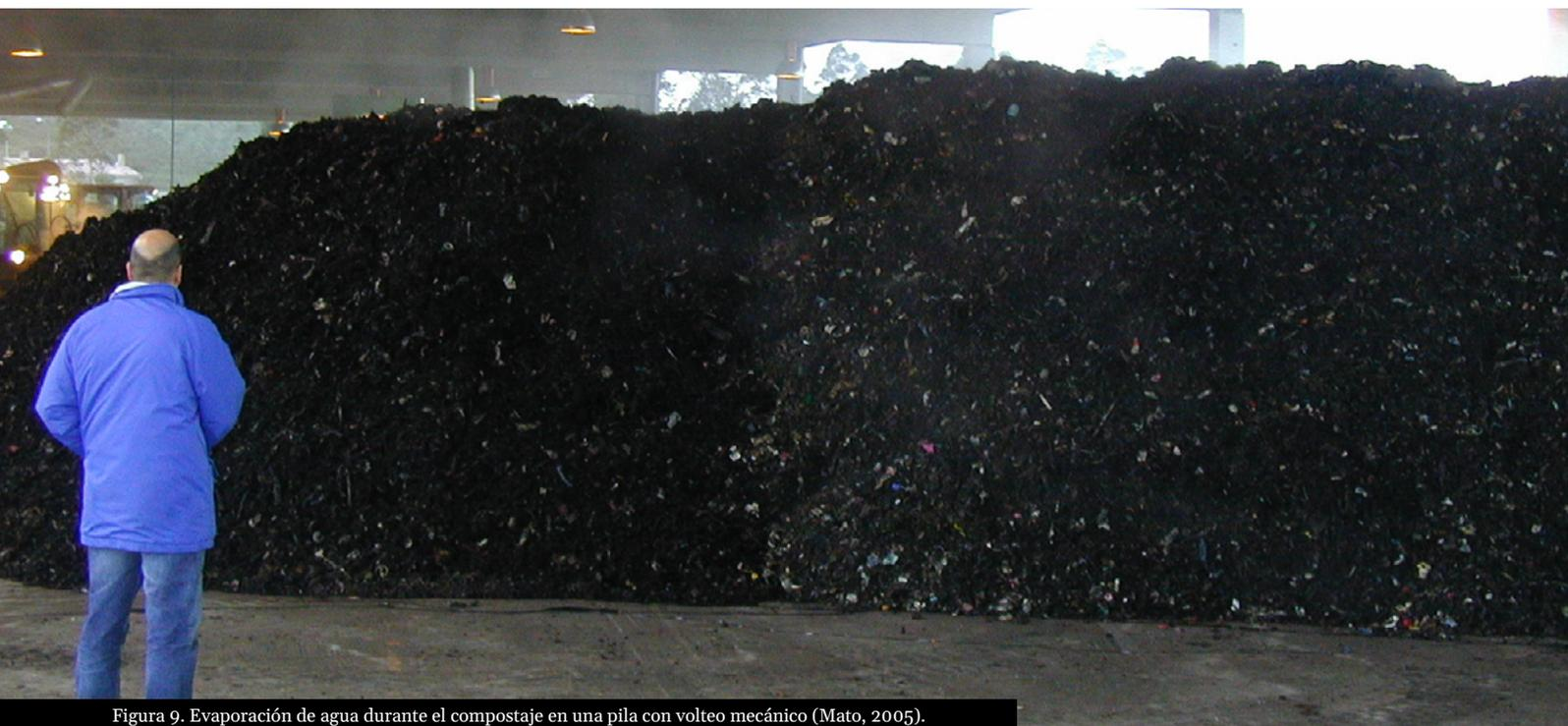
Figura 9. Evaporación de agua durante el compostaje en una pila con volteo mecánico (Mato, 2005).
