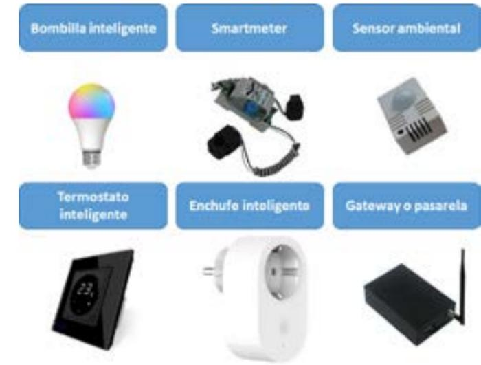
Figura 3. Diversos elementos de una solución IoT (CEDINT-UPM)
