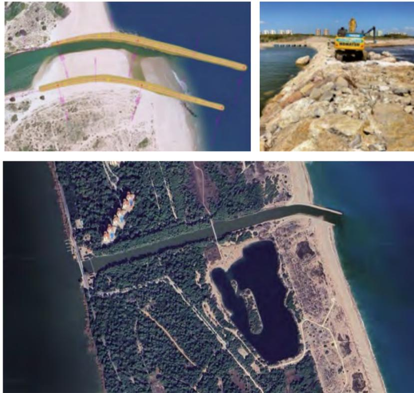
Figura 10. Prolongación de espigones en la Gola de Puchol © MITECO. En la foto aérea se observa la ampliación del espigón yerinada y a la izquierda, la Albufera © Google / Terabithia
