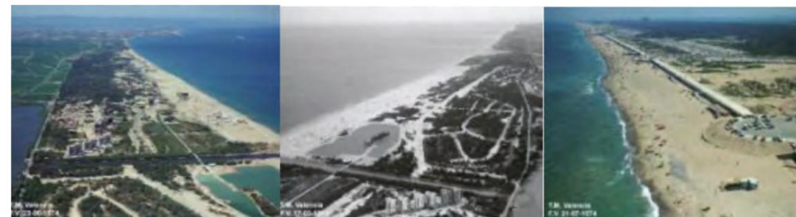
Figura 7. Fotografías aéreas de 1974. Destrucción del frente dunar: en tramo de actuación (izda.), al sur de la actuación en playa Devesa (centro) y por construcción de paseo marítimo en playa del Saler (dcha.)
