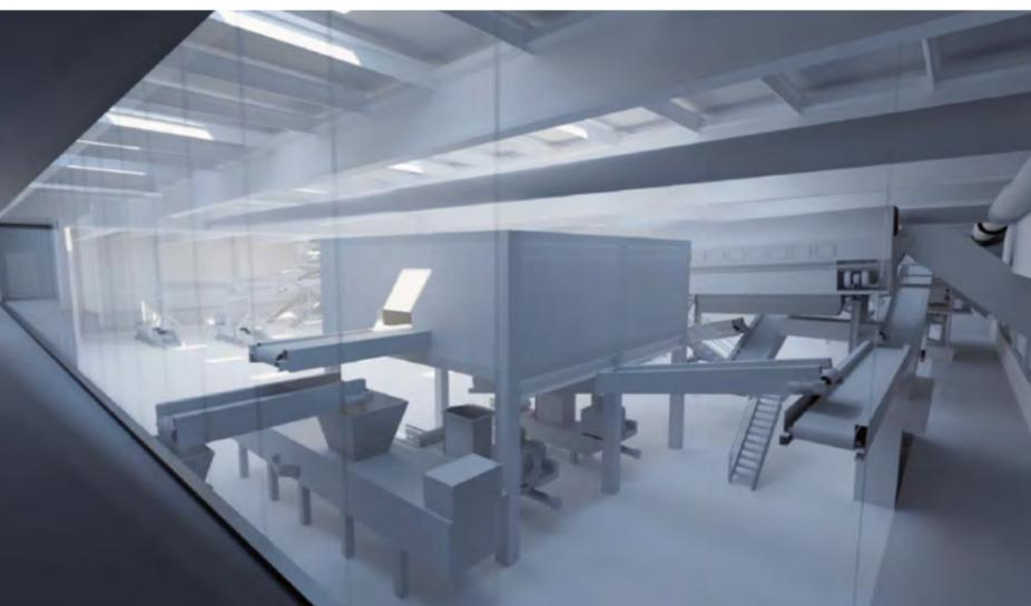
Esquema del modelo de maquinaria empleado para el tratamiento de residuos
