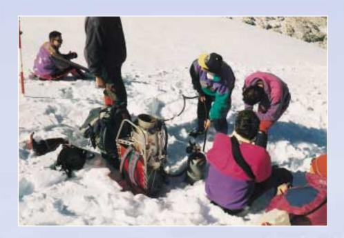
Sonda de vapor para practicar la perforación donde se alojara una baliza de control glaciar.
