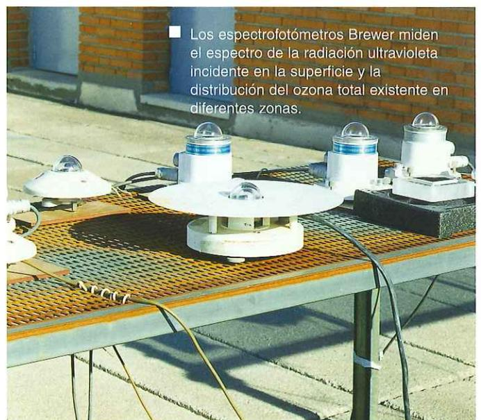
■ Los espectrofotómetros Brewer miden el espectro de la radiación ultravioleta incidente en la superficie y la distribución del ozono total existente en diferentes zonas.
