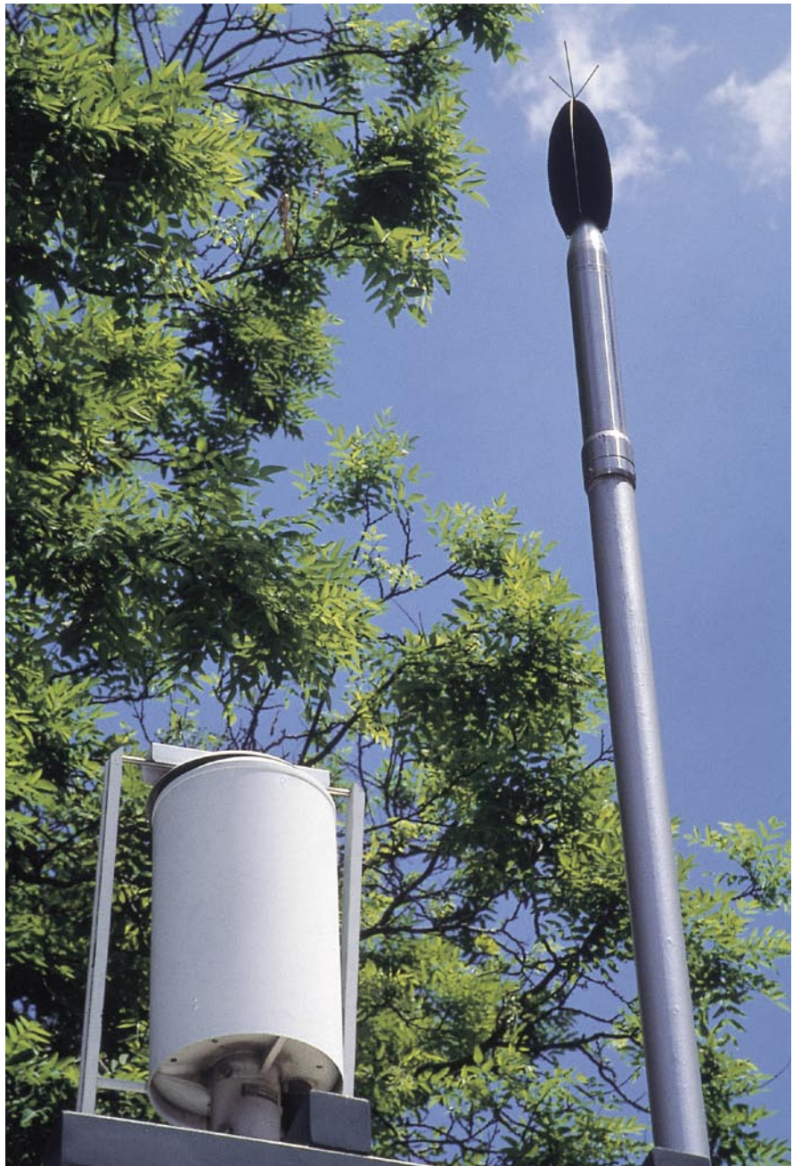
Sonómetro para medir la contaminación acústica
