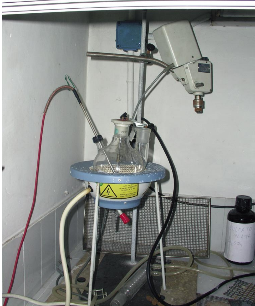
Reactor de metiléster en el laboratorio de botánica (ETSIA, Madrid).
