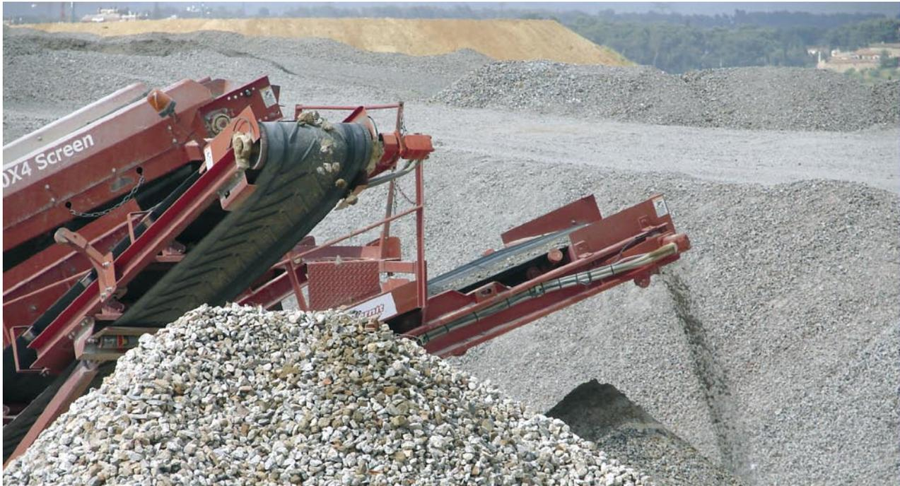
Planta de reciclaje de residuos de la construcción.
