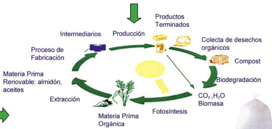
por un proceso industrial, se extrae el almidón, con el que se produce la materia prima biodegradable que consiste en unos gránulos blancos compuestos aproximadamente un 50% de material vegetal y otro 50% de material plástico degradable. Este material se somete a un proceso de extrusión por el que se fabrica el film a partir del que se confeccionarán las distintas clases de bolsas.
