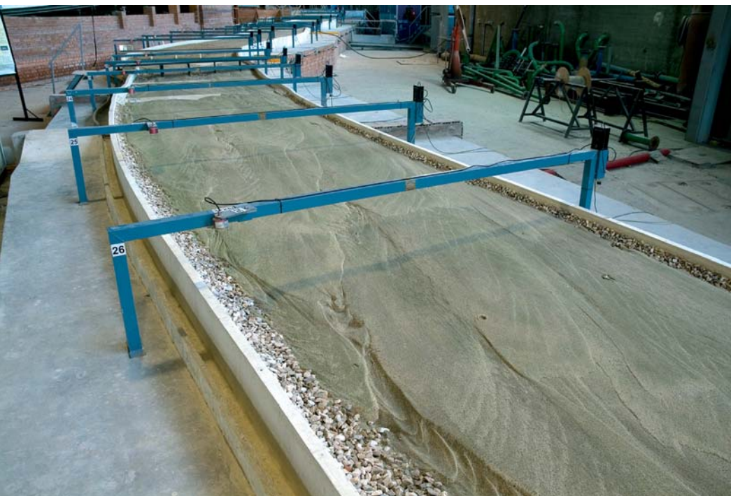
Modelo de lecho móvil del río Andarax.
