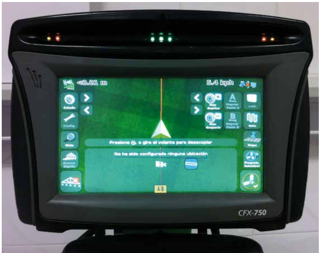
Monitor con barra de luces para ayuda al guiado.
