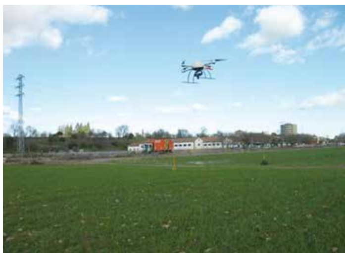
Figura 2. Ejemplo de UAV equipado con el sensor en rango visible volando una parcela de trigo.
