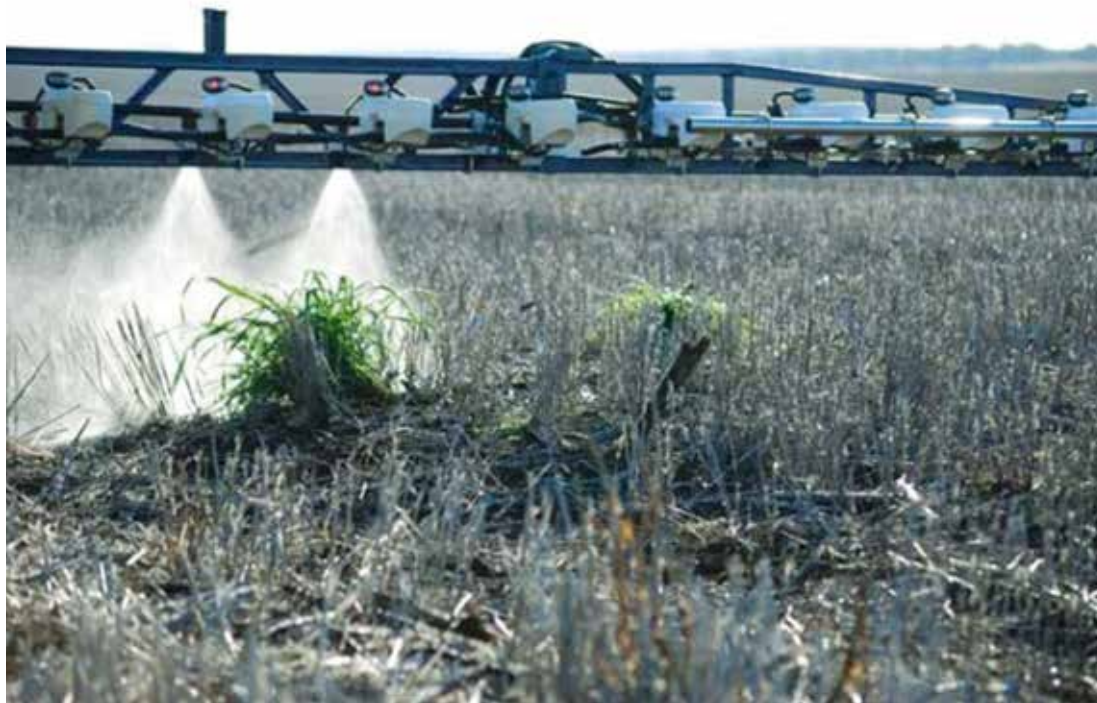
Aplicación selectiva de herbicida mediante sensores ópticos que detectan las malas hierbas. (Weed Seeker de Trimble.)
