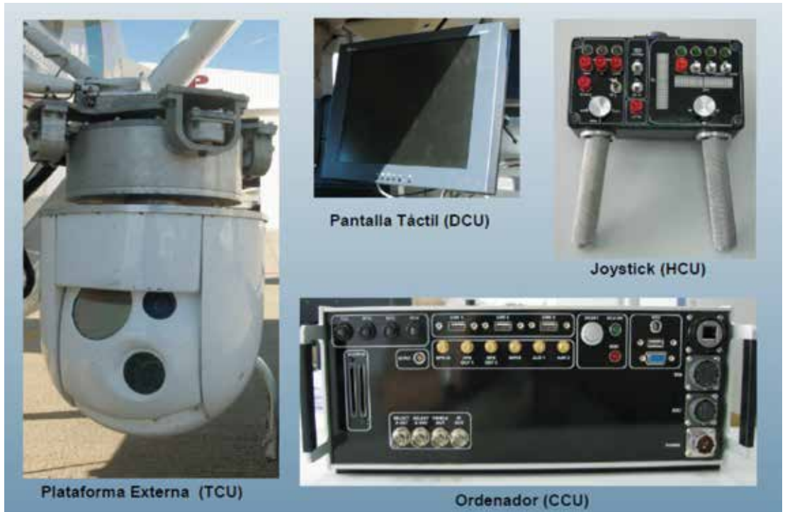
Figura 2. Equipos que integran el Sistema Aire, EINFOREX-B.
