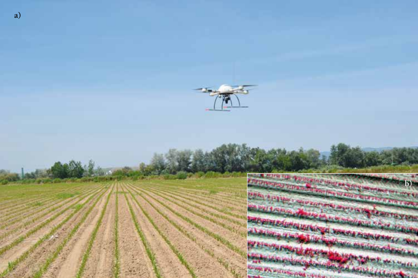
Figura 4. a) UAV equipado con sensor multiespectral volando una parcela de maíz infestada de rodales de malas hierbas en época temprana; b) Detalle de la imagen formada por las bandas Verde, Rojo e Infrarrojo Cercano sobre la parcela de maíz estudiada. Se pueden observar las líneas de cultivo y la presencia de malas hierbas entre las líneas.
