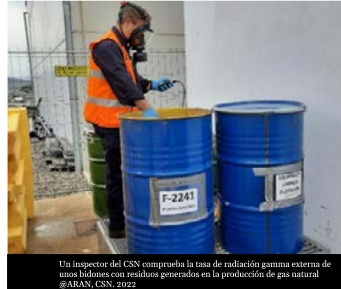
Un inspector del CSN comprueba la tasa de radiación gamma externa de unos bidones con residuos generados en la producción de gas natural @ARAN, CSN. 2022
