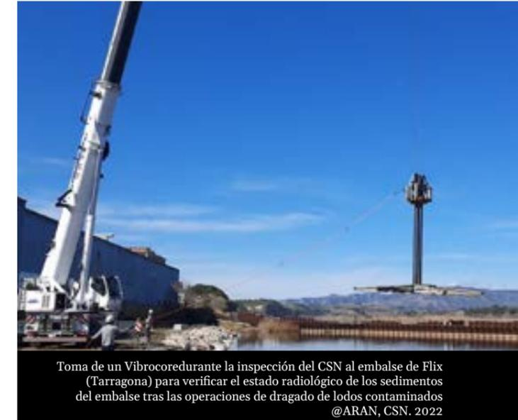
Toma de un Vibrocoredurante la inspección del CSN al embalse de Flix (Tarragona) para verificar el estado radiológico de los sedimentos del embalse tras las operaciones de dragado de lodos contaminados @ARAN, CSN. 2022
