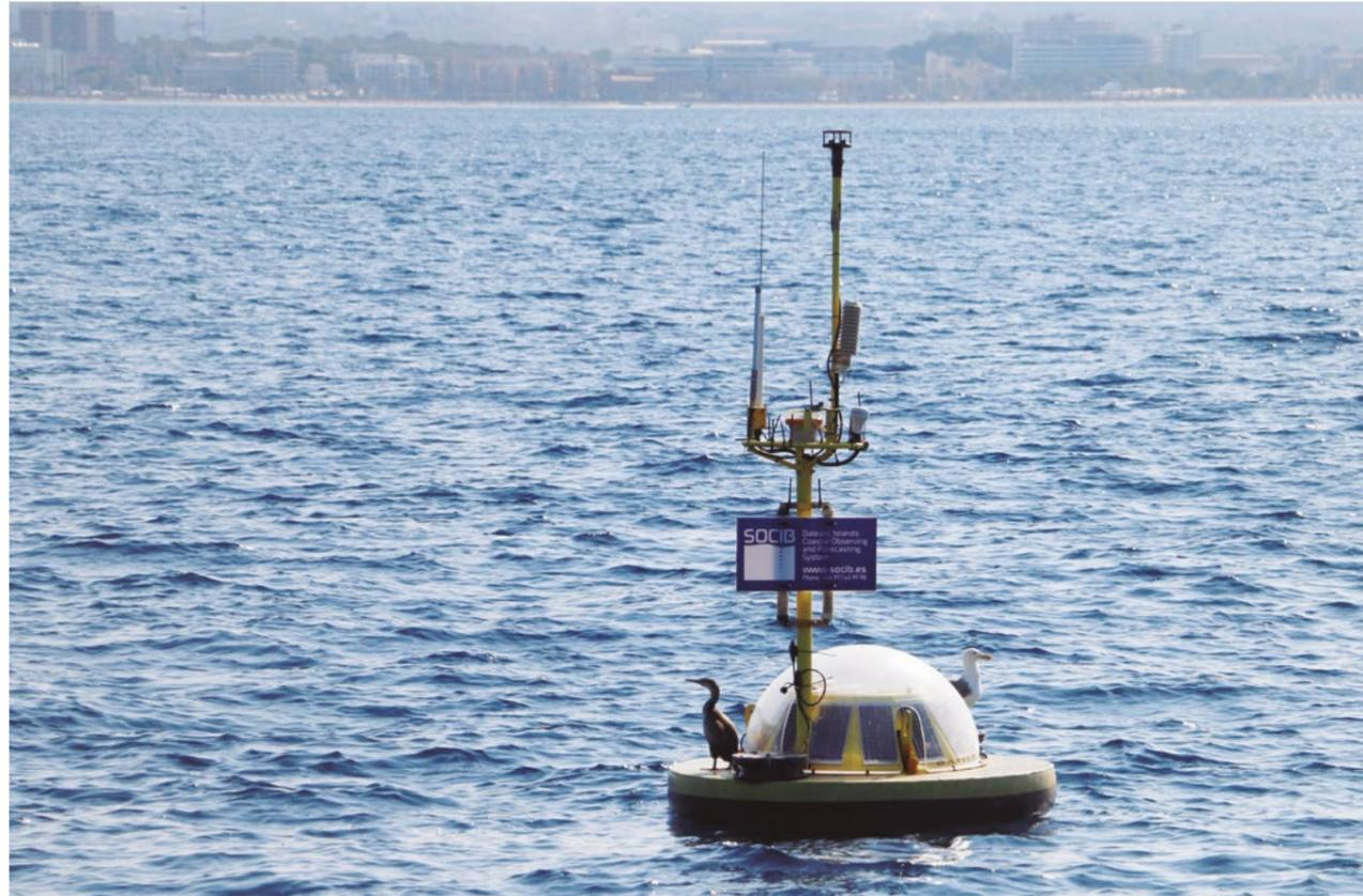
Boya de observación oceanográfica de SOCIB, instrumentada con múltiples sensores e instalada en la bahía de Palma
