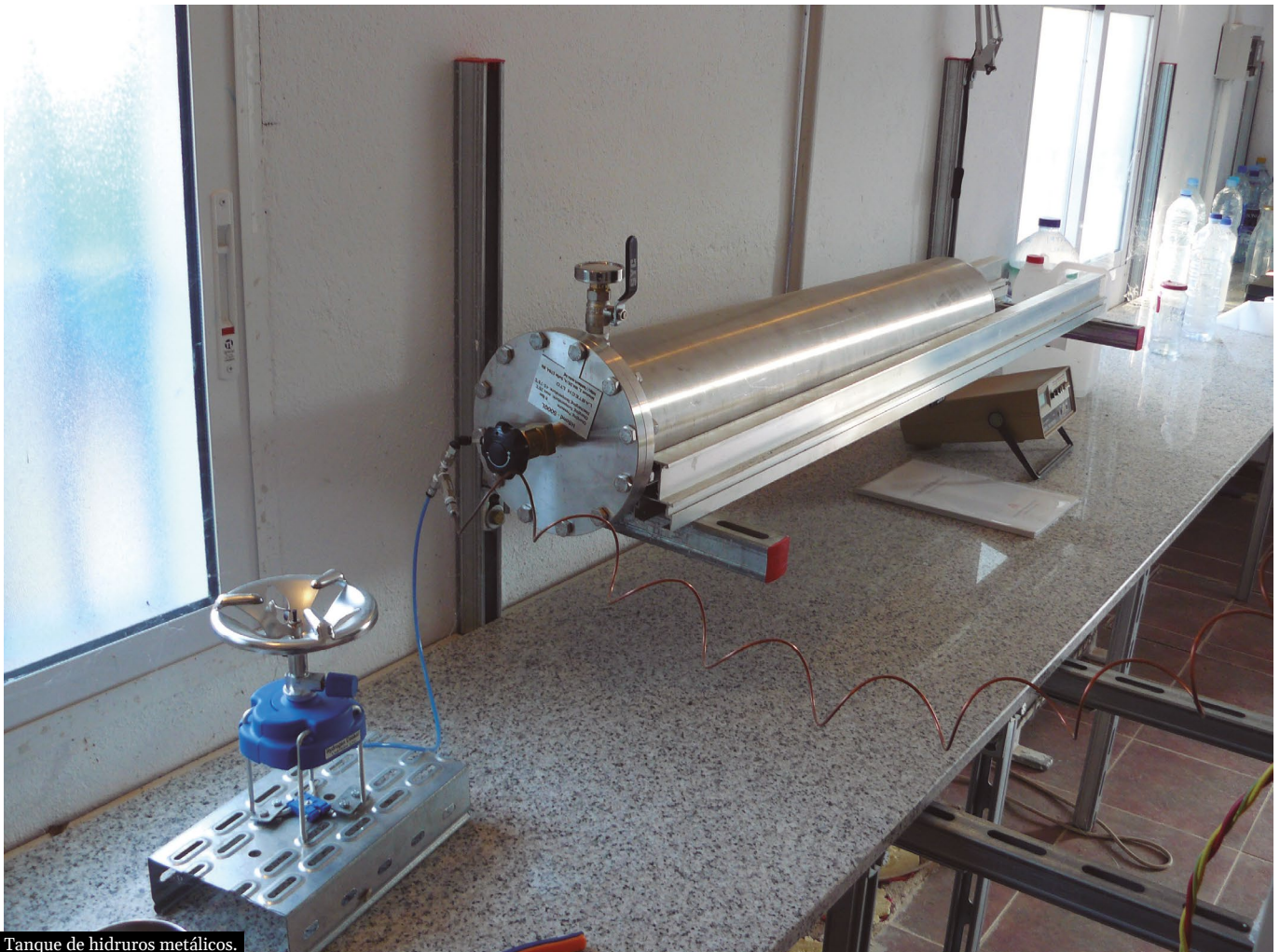
Tanque de hidruros metálicos.
