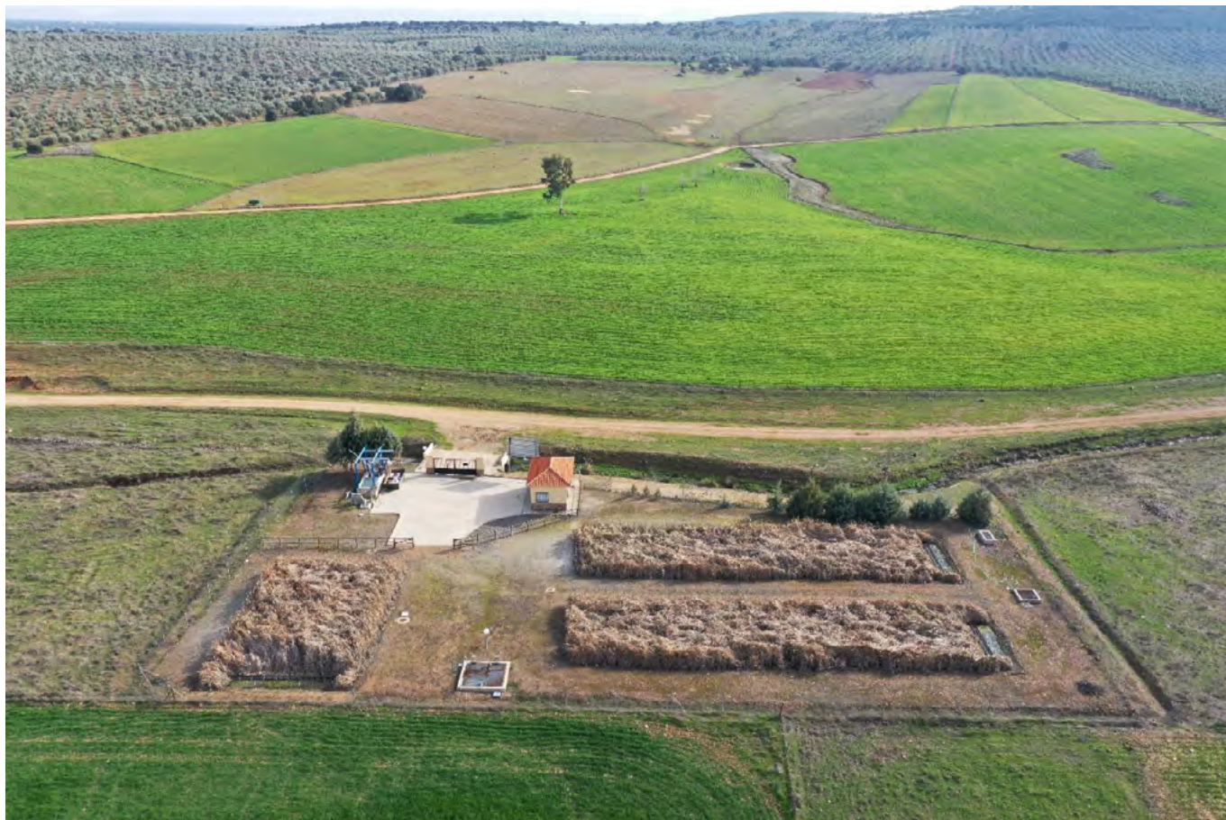
Foto 5. Filtro de macrófitas flotantes de Cabezarados, parte cinco EDAR con un coste conjunto de 4 181 660 euros. Se evidencia la inactividad invernal de la parte emergente de las plantas, por el clima mediterráneo continental con un periodo de heladas, despreciando la capacidad de autodepuración de redes tróficas plenamente funcionales en esta estación. Foto: R. Gosálvez.
